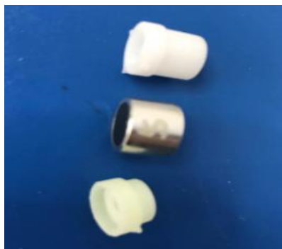
塑料轴套/铝轴套 (装配 磁铁和套接电机轴)
